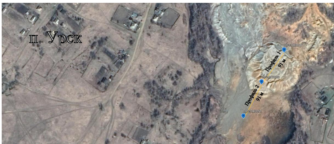
Рисунок 19 – Спутниковый снимок местности в районе Урского отвала и юго-восточной части п. Урск. На снимке обозначаются крайние точки и длина сейсмических профилей.
